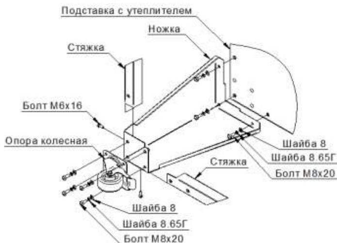
Рис. 4 - Схема сборки подставки
